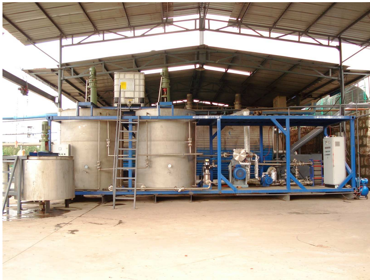
移动式成套乳化沥青设备—云南昆明工地实物图
